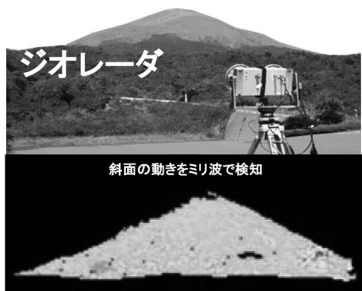
ジオレーダ ジオレーダはミリ波あるいはマイクロ波帯の電波を照射し、火山や地滑り斜面、鉱山切羽などで反射した成分を受信します。受信記録に差分干渉解析を適用することで、観測ターゲットの微小変位を常時モニタリングすることができます。レーダアンテナは水平及び垂直方向に回転する機構を備えていますので、面的なデータ集録が可能となります。
