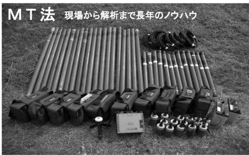
MT法 現場から解析まで長年のノウハウ MT法電磁探査は、自然の電磁場信号を用いて行なう比抵抗探査手法です。他の比抵抗探査手法よりも探査深度が深く、地下数十kmまで探査が可能です。このため、地殻構造調査や地熱構造調査に多くの実績があります。また、測定周波数の高いAMT (Audio Frequency MT) 法探査を用いることにより、地下1km程度までの詳細な探査も可能で、トンネル掘削前の土木地質調査や断層調査への実績があります。測定システムは可搬性に優れ、騒音振動はありません。
