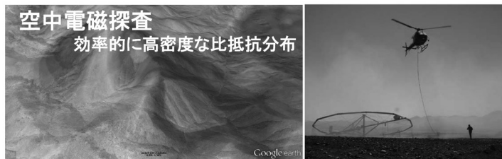
空中電磁探査 効率的に高密度な比抵抗分布 空中物理探査は、固定翼機やヘリコプターを用いて行う物理探査手法です。空中から調査を行うため、地表からアクセスが困難な地区の情報を容易に得ることができ、1日に数百kmにおよぶデータを取得することが可能です。測定項目には、磁場強度、重力、放射線強度および電磁場強度があり、お客様のニーズに合わせた測定項目をご提案いたします。
