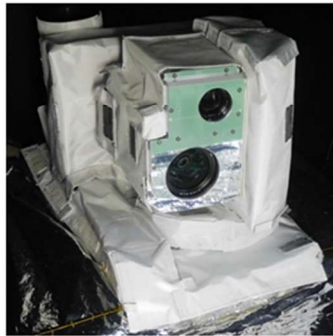
「きぼう」船外プラットフォームに取り付ける 次世代ハイビジョンカメラ (HDTV-EF2)
