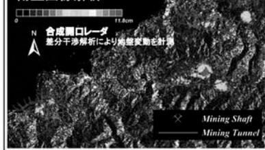
人工衛星に搭載された光学センサーやレーダセンサーは、数m程度の高い空間分解能で、数十～数百km四方の広範囲の地表情報を記録し、画像化します。リモートセンシングでは、衛星画像を解析することにより、地球上のあらゆる地域の情報を定期的に収集することが可能で、人工衛星が定期的に地球を周回しますので、地表状況の定常監視に応用できます。
