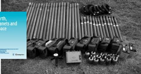
MT法電磁探査は、自然の電磁場信号を用いて行なう比抵抗探査手法です。他の比抵抗探査手法よりも探査深度が深く、地下数十kmまで探査が可能です。このため、地殻構造調査や地熱構造調査に多くの実績があります。また、測定周波数の高いAMT (Audio Frequency MT) 法探査を用いることにより、地下1km程度までの詳細な探査も可能で、トンネル掘削前の土木地質調査や断層調査への実績があります。測定システムは可搬性に優れ、騒音振動はありません。
