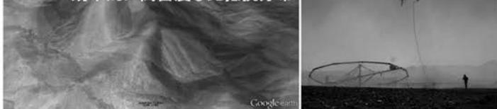
空中物理探査は、固定翼機やヘリコプターを用いて行う物理探査手法です。空中から調査を行うため、地表からアクセスが困難な地区の情報を容易に得ることができ、1日に数百kmにおよぶデータを取得することが可能です。測定項目には、磁場強度、重力、放射能強度および電磁場強度があり、お客様のニーズに合わせた測定項目をご提案いたします。
