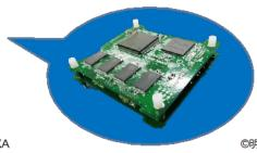
高機能CubeSat用OBC 諸元表 項目 性能 サイズ 96 mm×90 mm×21 mm (基板表面部品含む) 質量 110 g Typ.
